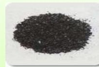
反射炉から産出されるカラミを水砕した黒色の粒状物。セメントの原料、コンクリート用細骨材などに使用されます。
